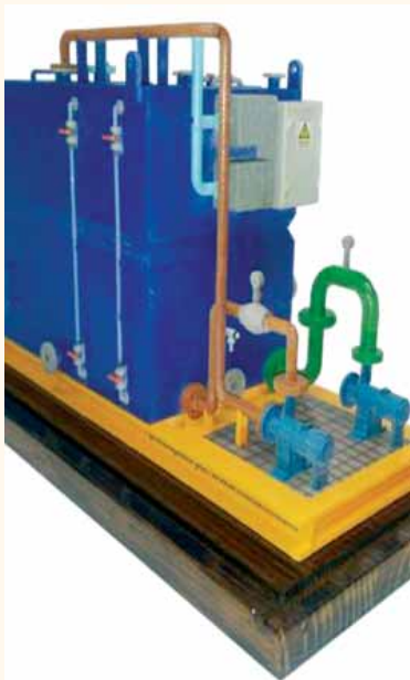
Imagen del prototipo realizado a DFM Aguas, planta compacta modular para barcos.
