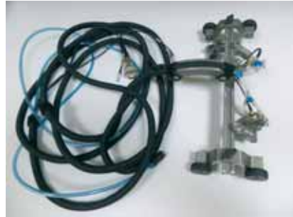
Equipamiento empleado en END de materiales mediante ultrasonidos.
